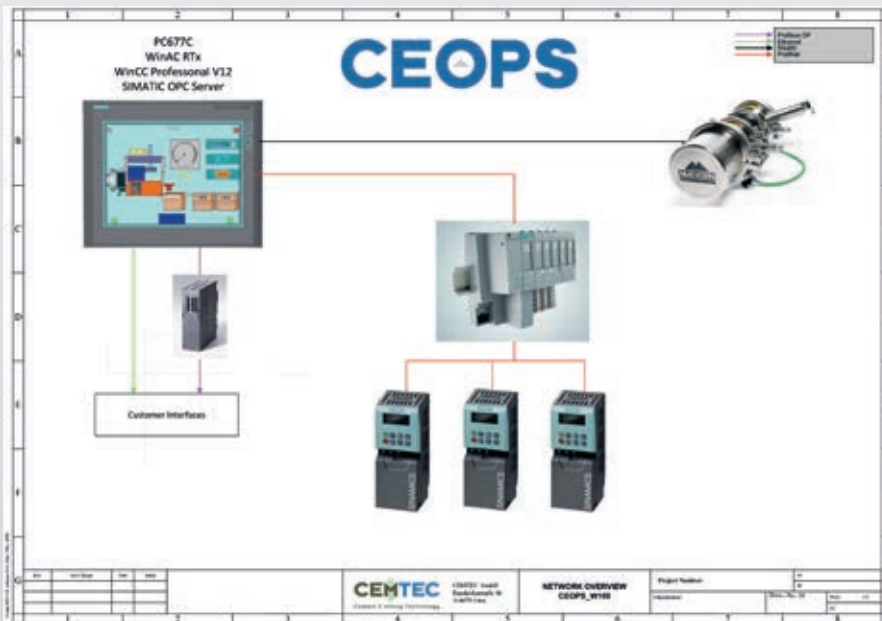
Schematische Darstellung der eingesetzten Siemens-Komponenten – Das Malvern-Messsystem ist direkt an den Siemens-IPC angebunden. Die Umrichter und die »ET 200SP«-Klemmen sind via Profinet verbunden. Das Interfacemodul sorgt für die weitere Anbindung an die gesamte Anlage.
