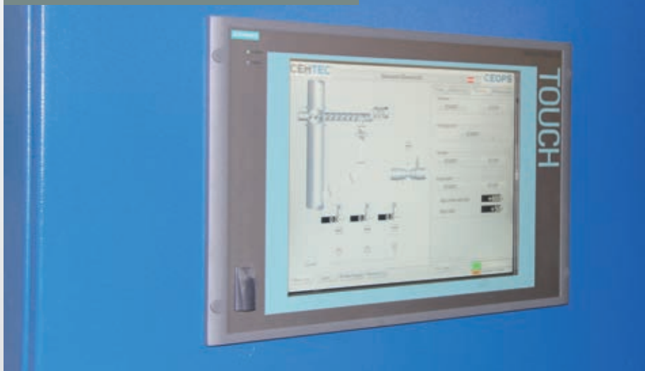
Der »IPC 677C« mit 15" Touch TFT von Siemens ermöglicht vielfältige Darstellungen und gibt einen optimalen Überblick zum Prozess.
